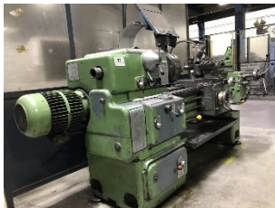
Boehring 44SR Spitzenhöhe 250 mm Spitzenweite 1.200 mm Dreibackenfutter Revolver-Reitstock
