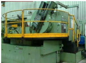
MAAG SH250 Baujahr 1970/2008 Max Durchmesser 2.500 mm Modul 2 / 30 / 50
