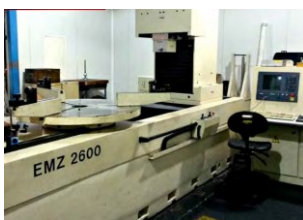
Höfler EMZ 2600 Max. Durchmesser 2.600 mm Max. Werkstückgewicht 4.500 kg
