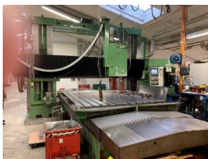
KOLB KBNG CNC Siemens 840C X/Y/Z/W 3.000/2.500/500/1.600 Tisch 3.250x.2500
