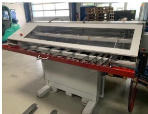
Breuning ILS-RBK 10016 Baujahr 2007 Stangenlänge 1.600 mm Durchmesser 5 bis 105 mm
