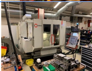
Hermle C800U Heidenhain TNC430 X-Y-Z 800/600/500 mm NC-Schwenk-/Rundtisch Schwenkbereich 20/+90 ° Spindel 8.000 min-1
