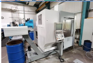
Deckel-Maho DMC 635V Baujahr 2007 CNC Heidenhain iTNC530 Spindel 12.000 min-1
