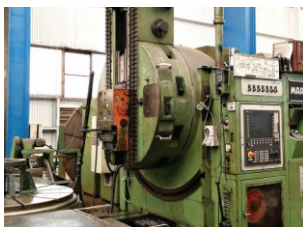
MAAG SH 250/300 Baujahr 1976/2007 Max. Durchmesser 3.000 mm CNC Siemens 840DC
